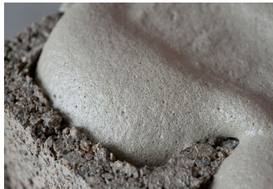
Abbildung 2: Foto einer Zelle eines Leichtbetonsteins, die mit Airium gefüllt wird (BlockFill-Anwendung) – Quelle: HOLCIM Beton GmbH
