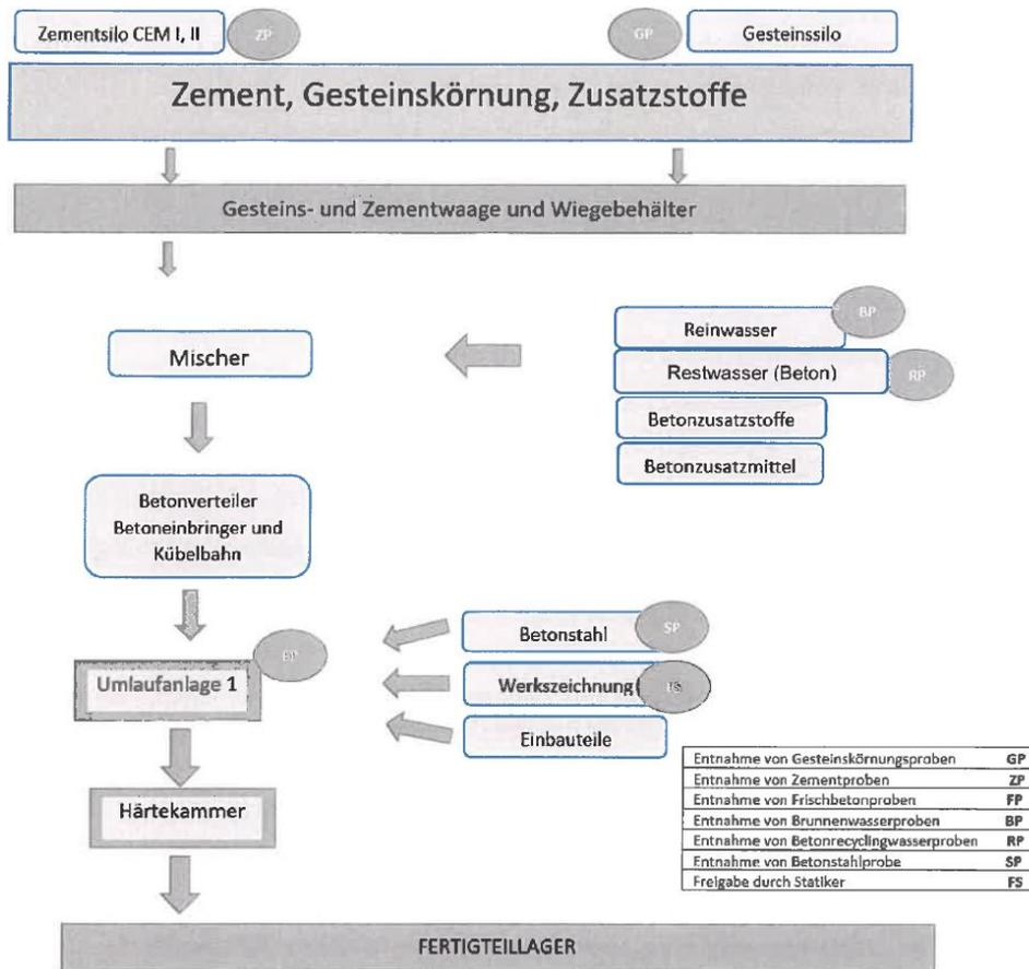
Abbildung 1: Beispiel eines Flussdiagramms Herstellungsprozess
