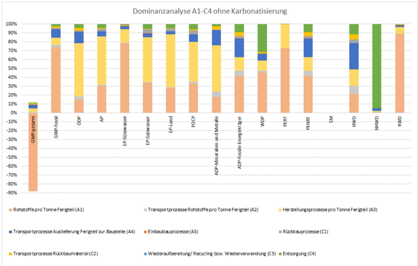
Abbildung 3: Dominanzanalyse Module A1-C4 Holzmantelbetonsteine bzw. -platten
