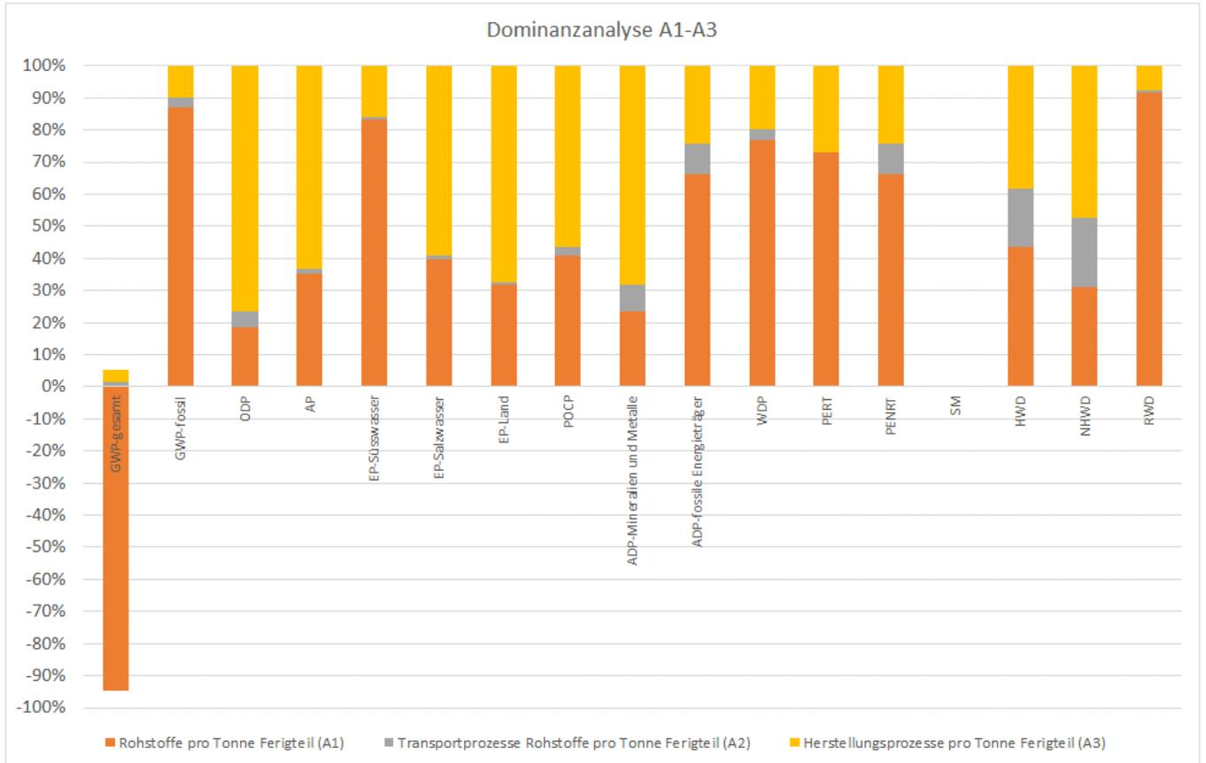
Abbildung 5: Dominanzanalyse Module A1-A3 Holzmantelbetonsteine bzw. -platten
