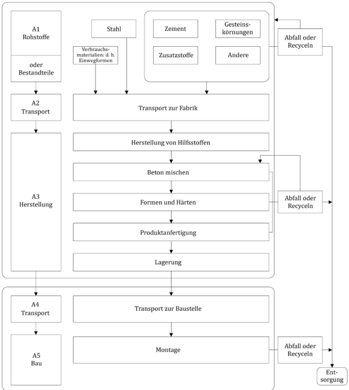
Abbildung 1: Flussdiagramm Herstellungsprozesse (A1-A3) Betonfertigteile inkl. Einbau (A4-A5) [3]
