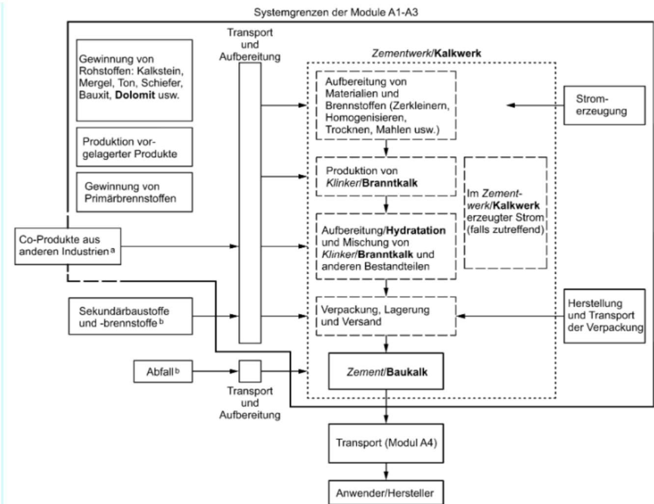
Abbildung 2: Systemgrenzen der Zementproduktion nach ÖNORM EN 16908
